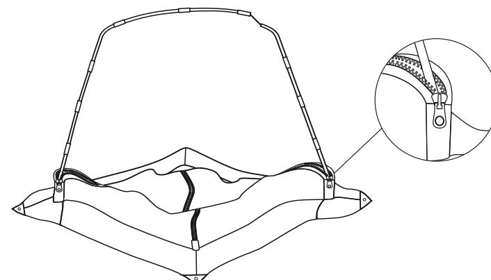
7. Собранный дверной каркас вставить в полотно распашной двери, застегнуть молнию поверх дверного каркаса.
